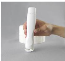
Step 4: さらに 30 秒待ちます。 次に、乾燥した綿棒を使用して、測定面を完全に乾燥させます。液体がプローブの電子機器に入るのを防ぐために、乾燥する前にプローブの測定面を上に向けないでください。
