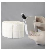
エタノール (76%) で湿らせた綿を使用して、カートリッジの外側とデバイスのチューブ内のライトダイオードをクリーニングすることもできます。 再度使用する前に、チューブの内側を乾いた綿で拭いて乾かしてください。
